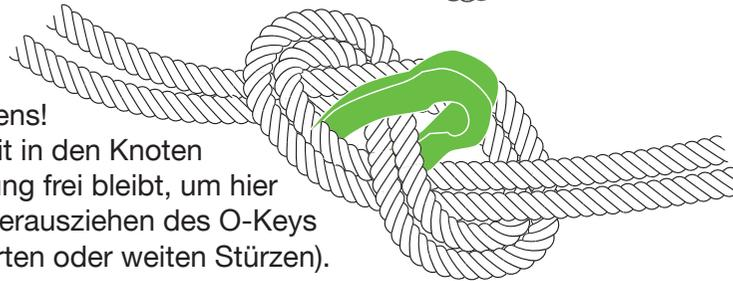
Zum Entfernen des O-Keys wird an der Unterseite etwas gedrückt und oben am O-Key gezogen. Durch den nach dem Entfernen des O-Keys entstandenen Platz lässt sich der Knoten nun leicht öffnen. Zum Herausziehen des O-Keys nach weiten oder harten Stürzen kann der O-Key einfach mit Hilfe eines Karabiners herausgezogen werden.
