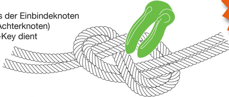
Der O-Key wird in den lose gebundenen Achterknoten eingeführt. Hierbei erfolgt die Sicherheitskontrolle des Knotens! Wichtig: Den O-Key nur soweit in den Knoten stecken, dass die obere Öffnung frei bleibt, um hier später einen Karabiner zum Herausziehen des O-Keys einführen zu können (nach harten oder weiten Stürzen).
